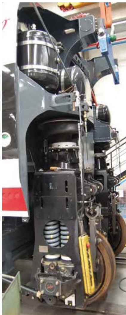
Figura 9. Rodadura y suspensiones en el nuevo Talgo AVRIL.
