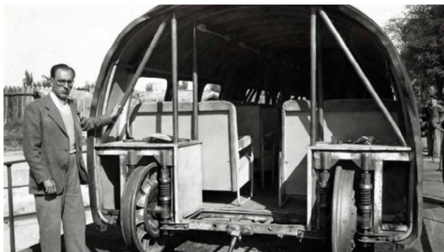
Figura 4. Sistema de rodadura implementado en el prototipo Talgo I.
